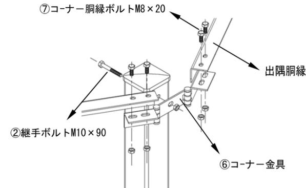
※ 胴縁は出隅胴縁を使用し、ボルト用の孔を開けます。コーナープレートとパネルをボルトで連結します。
